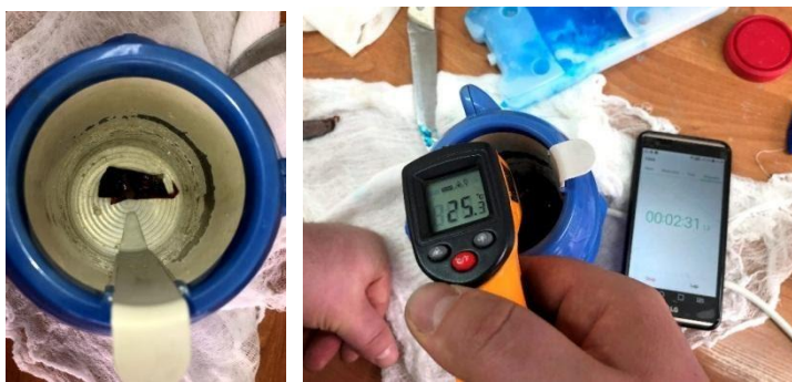
Рисунок 4 - а – биологическая ткань(говяжья печень), помещенная в термостат(модель брюшной полости); б - процесс динамической термометрии в области укладки охлаждающего агента на биологическую ткань, помещенную в термостат
