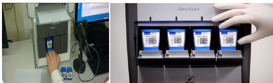
Сурет 2 - GENE-XPRT - ТМБ алғашқы сатыда және туберкулезге қарсы бірінші қатардағы препараттарға сезімталдығын гендік деңгейде анықтайтын диагностикалық аппарат. Нәтижесі 2 сағатта дайын болады
