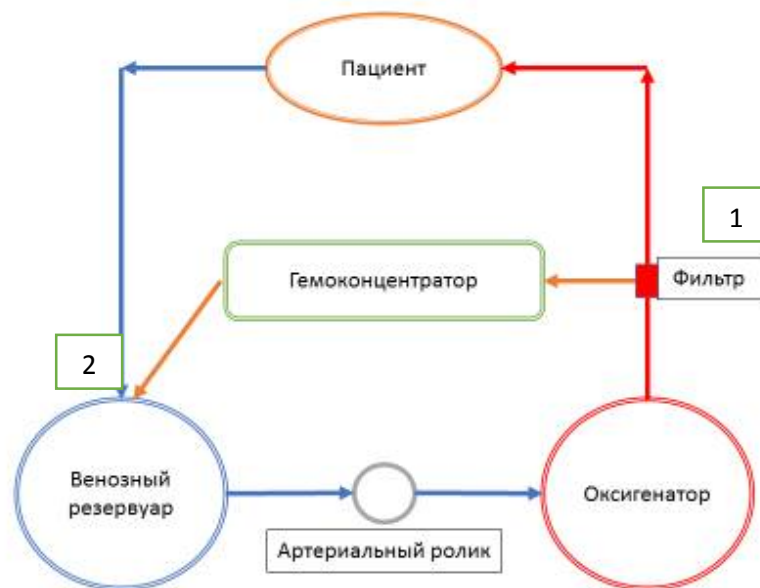
Рисунок 1 - Схема одновременной (классической) ультрафильтрации
