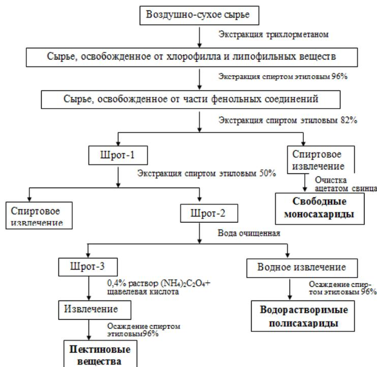
Рисунок 1 – Схема выделения углеводов из слоевища *C. islandica*
