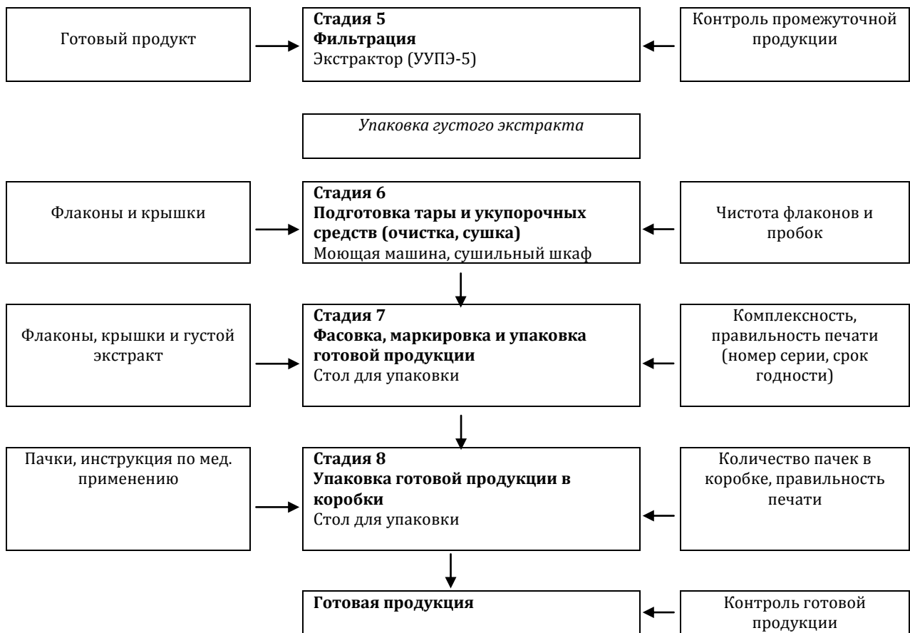
Рисунок 2 - Технологическая схема получения густого экстракта из травы Cichorium intybus L.
